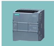
**Pos 1:** SIMATIC S7-1200, CPU 1212C, CPU compacta, DC/DC/DC, I/O integrada: 8 DI DC 24V; 6 DO 24V DC; 2 AI 0-10V DC. Alimentación: DC 20,4-28,8V DC, Memoria de programas/datos 100 KB.
